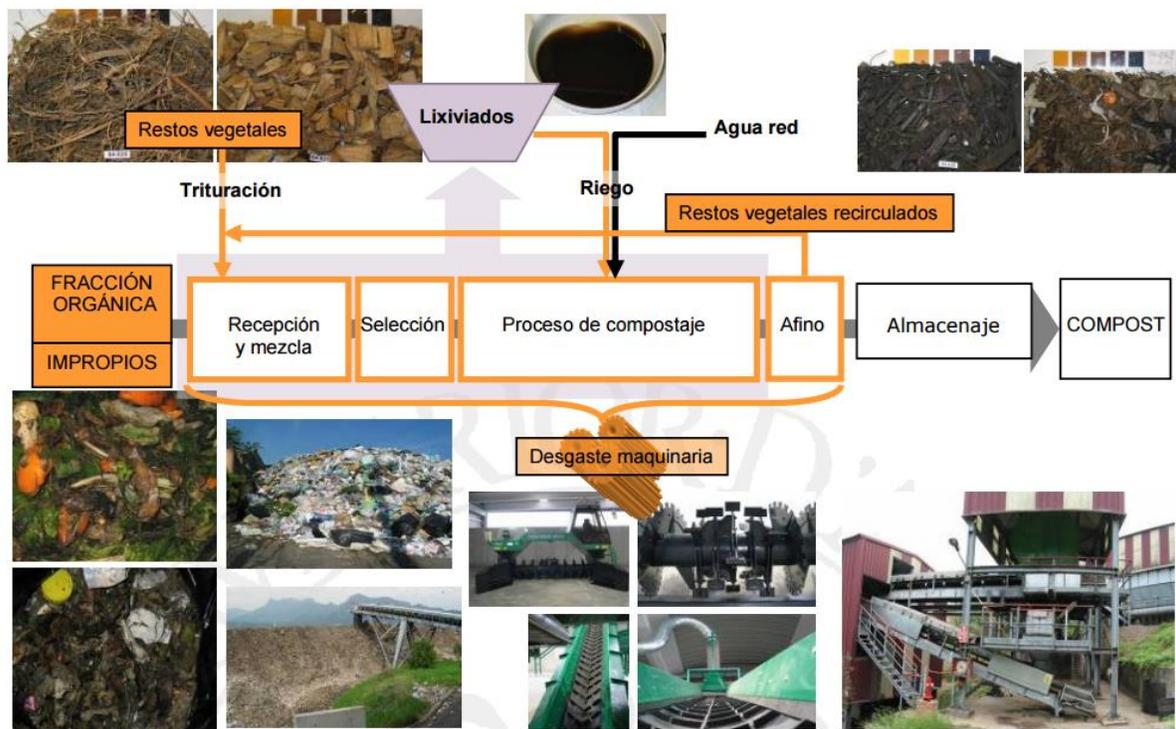
Figura 42. Procesos en una planta de compostaje industrial. Fuente: Cogersa.
